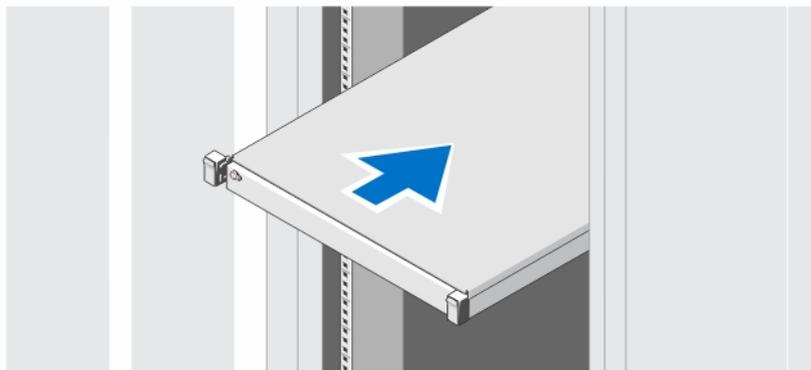
Ilustración 1. Instalación de los rieles y del sistema en un bastidor
